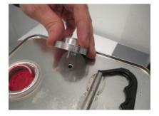
Vissez l'accessoire de purge en utilisant les vis fournies. Percez un trou supplémentaire dans le pot de peinture pour permettre aux gaz de s'échapper.
